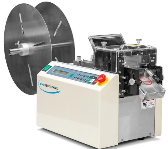
Die Schneidemaschine ist dazu vorgesehen, Kabel, Schläuche, Flachbandleitungen und Litzen auf eine voreingestellte Länge zuzuschneiden.
