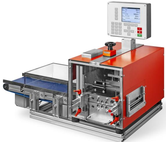
Der Schneidmaster 15/130K ist eine elektropneumatische Schneidemaschine zum Schneiden von Schrumpfschläuchen, Gummi, Folien, Vinyl, Kunststoffprofile, Gummiprofile, Kapillare, Schläuche bis 15 mm Durchmesser, je nach Material
