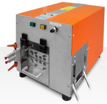
Das Material wird zwischen zwei Antriebsbändern mit einer regelbaren Geschwindigkeit bis 56 m/min zum Schneidsystem transportiert und dann dort ohne Schlupf geschnitten. Dadurch sehr hohe Längengenauigkeit.
